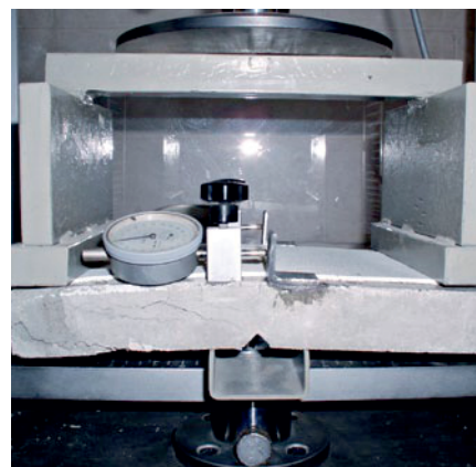
Статическое испытание перекрытия трещин согласно стандарту EN 1062-7 (метод А)
