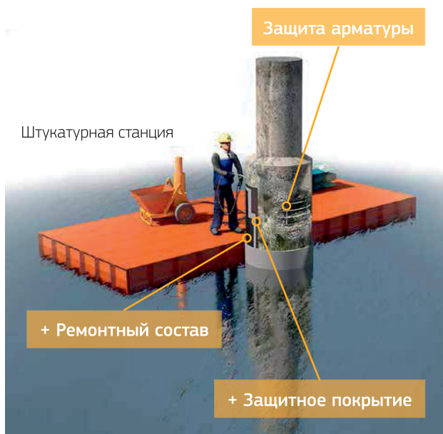
Ремонт надводной части
