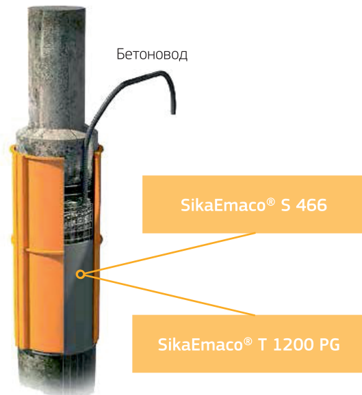
Ремонт с применением опалубки
